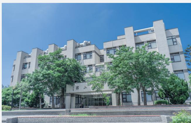
科學二館是一棟地上 5 層樓地下 1 層樓，共 6 層樓之建築。由藍之光、仲還澤建築師事務所規劃設計，信助營造所建造，為 RC 鋼筋混凝土結構，總樓地板面積  $13174.5\text{ m}^2$ ；於 1991 年 12 月完工，1992 年 3 月 5 日取得執照。
